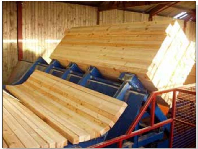
1. Destacking using tilt hoist
